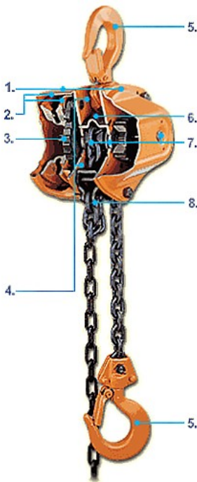
Рис. 3: 1 - Стальной штампованный корпус; 2 - Двойное защитное покрытие; 3 Тормозной механизм; 4 - Двойные надежные защелки у трещотки; 5 Нижний и верхний крюк; 6 - Направляющие грузовой цепи; 7 - Игольчатый подшипник; 8 - Закрепление конца цепи.
